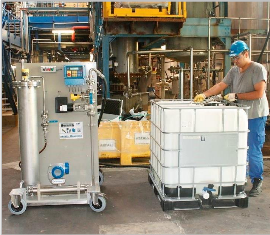
Eichfähiges Abfüllsystem für IBC mit dem Krohne Massedurchflussmesser Optimass 7300C
