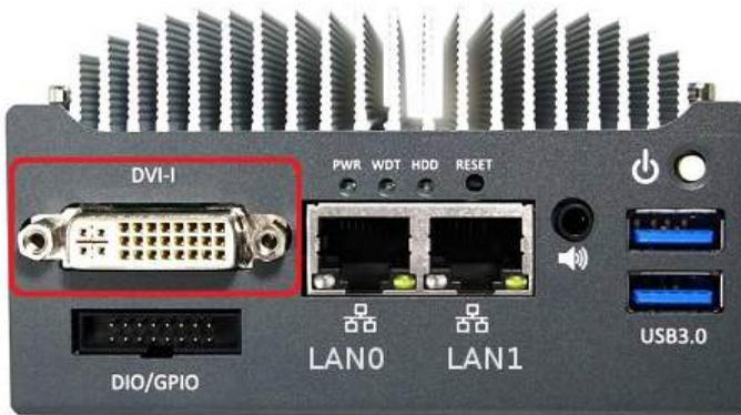
Schließen Sie den Monitor mit einer Auflösung von mindestens 1280x1024 Pixel an die DVI-I-Buchse an. Wenn Sie einen VGA-Anschluß am Monitor besitzen, verwenden Sie einen Adapter.
