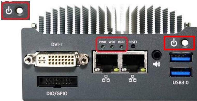
Mit dem Taster wird der PCC 400 eingeschaltet. Schalten Sie den PCC erst ein, wenn alle Anschlüsse eingesteckt und festgeschraubt sind.
