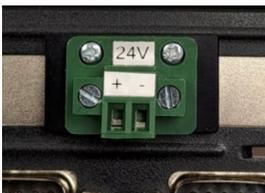
Der PCC wird mit einer Spannung von 8 bis 29 VDC betrieben. Stellen Sie sicher dass 29 V nicht überschritten werden, da das System sonst zerstört wird.
