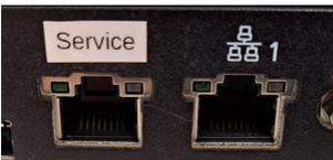
Von den zwei LAN-Anschlüssen ist LAN2 ab Werk auf die feste IP-Adresse 192.178.1.77 eingestellt. LAN2 kann für den VNC-Viewer auf einem externen PC verwendet werden. Sollte z. B. ein Laptop direkt an den PCC angeschlossen werden, muss dem Laptop auch eine feste IP-Adresse zugewiesen werden.
