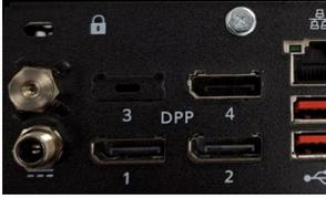
Schließen Sie den Monitor mit einer Auflösung von 1920 x 1080 Pixel (mindestens 1280x1024 Pixel) an den Display Port 1 oder 2 an.
